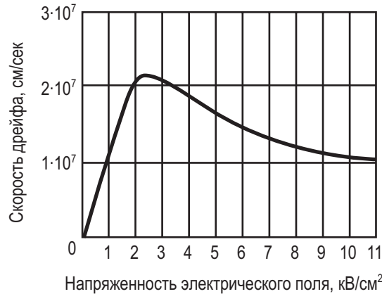
Рис. 8.4. Зависимость скорости дрейфа от напряженности поля для GaAs. Пороговая напряженность поля E_{П} , при которой начинается участок ОДС, по экспериментальным данным равна \sim 3,2 кВ/см. Значение подвижности при низких полях равно \sim 8000 см 2 /В·с, начальное значение дифференциальной отрицательной подвижности \sim 2400 см 2 /В·с. Напряженность поля, при которой кончается участок ОДС, приблизительно равна 20 кВ/см.
